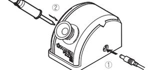
Brancher l'adaptateur secteur à la prise jack et insérez la pointe du fer dans le réceptacle. La pointe de fer est brossée et nettoyée.
