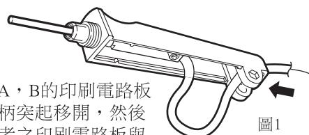
將手柄A、B的印刷電路板都從手柄突起移開，然後取出二者之印刷電路板與發熱元件。
