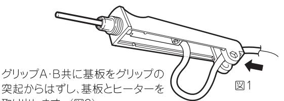
グリップA・B共に基板をグリップの突起からはずし、基板とヒーターを取り出します。(図2)
